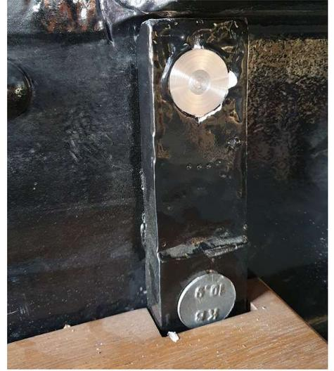
Beschädigter Deckel (links), Ersatzdeckel mit neuer Lederdichtung
