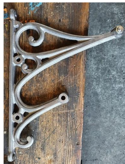
Die nachgegossenen Gepäckträgerkonsolen vor und nach dem Verbohren
